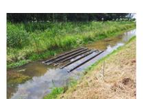
Der Wasserverband Rivierenland testete ein System, mit dem man nährstoffreiche Gräben reinigen kann. Stickstoff und Phosphat werden dabei auf natürliche Weise durch Mikroorganismen gebunden und aus dem Wasser heraus gefiltert.
